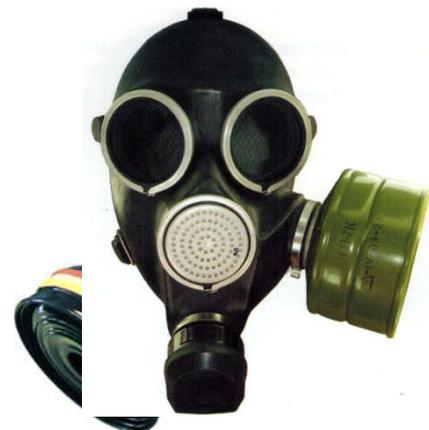
Лицевая часть бывает трех ростов (1;2;3). Для подбора лицевой части необходимо определить замер вертикального (замкнутая линия, проходящая через макушку, щеки и подбородок) и горизонтального (замкнутая линия, проходящая через лоб, виски и затылок) обхвата головы. Результаты округляют до 0,5 см.
