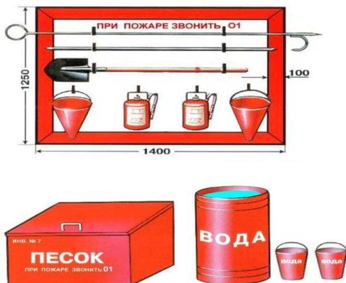
Рисунок 6 - Пожарный щит первичных средств пожаротушения
