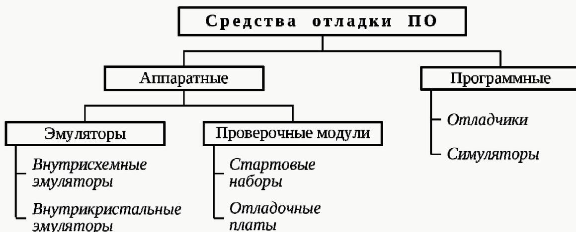
Рисунок 16.1 – Классификация средств отладки программного обеспечения
