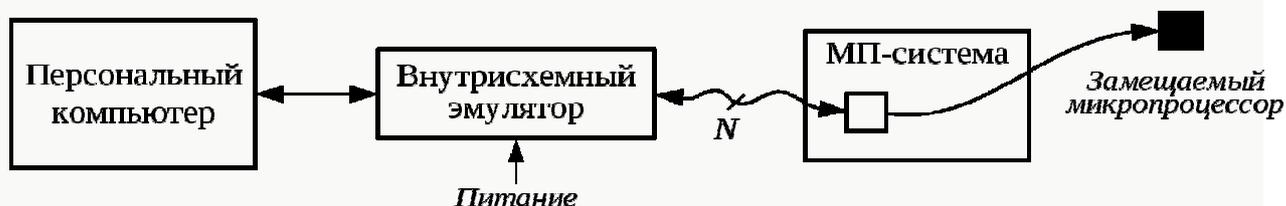
Рисунок 16.2 – Отладка с помощью внутрисхемного эмулятора
