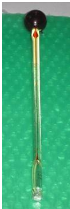
Рис. 5. Катанермометр, прибор для измерения скорости движения воздуха
