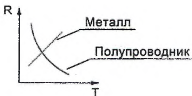
Рисунок 12- Температурная зависимость сопротивления металла и полупроводника
