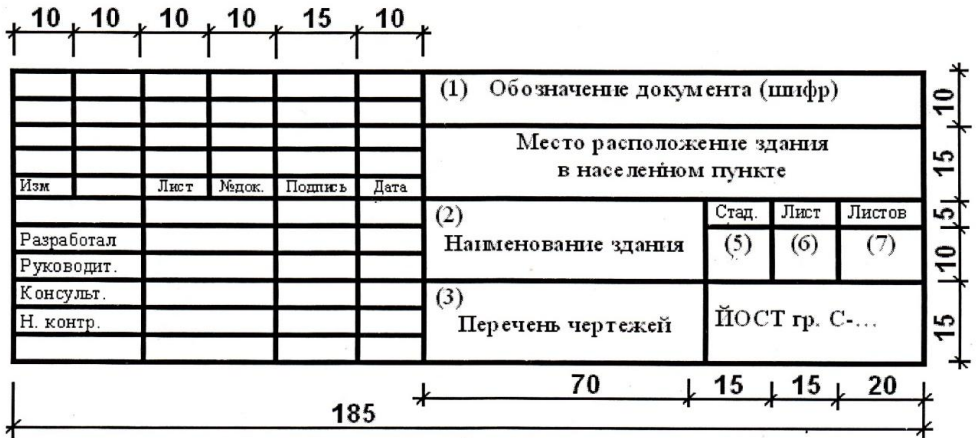
Рисунок Д.3 – Основная надпись на чертежах АС
