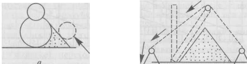
Рис.1 Применение метода подсыпки при возведении: а – дольмена; б – колонны
