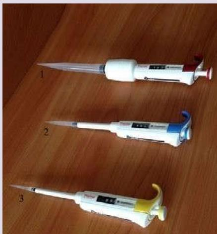
*Рис. 5.* Пипетки дозаторы одноканальные переменного объёма:
