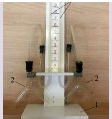
соединяются с сосудами Ландольта с помощью пластиковой трубки с пробками (*рис. 5*). Между манометрическими трубками на панели находятся шкалы для наблюдения уровня жидкости в трубках. Окрашенной жидкостью может быть раствор любого красителя в воде.
