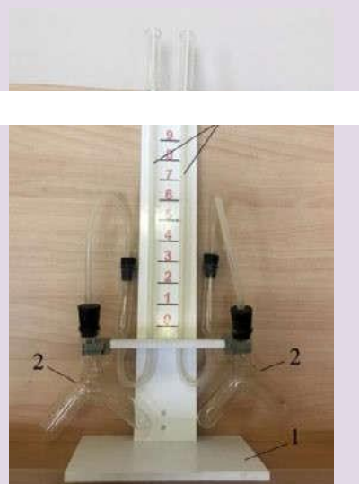
Рис. 4. Прибор для демонстрации зависимости скорости химических реакций от различных факторов: 1 — подставка; 2 — сосуды Ландольта; 3 — манометрические трубки
