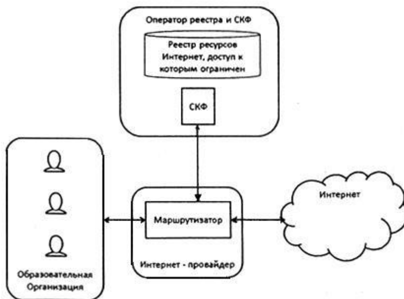
Рис.4. Схема работы контент-фильтрации при размещении у интернет-провайдера
