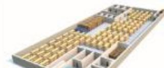
Убежище — защитное сооружение гражданской обороны, предназначенное для защиты укрываемых в течение нормативного времени от расчетного воздействия поражающих факторов:
