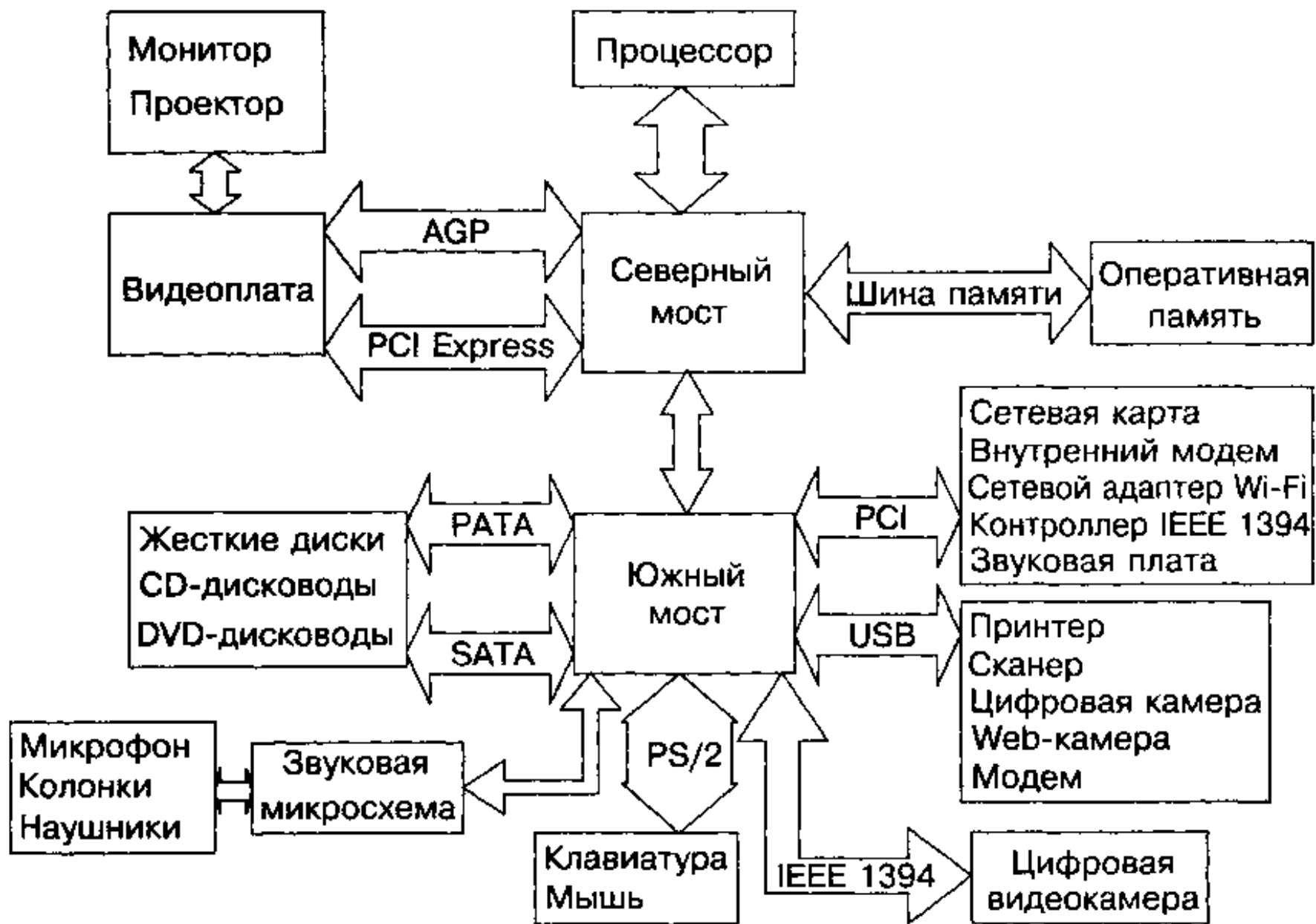
Рис. 1.3. Логическая схема системной платы
